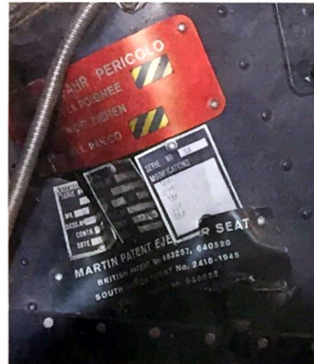
Das durch den Absturz verbogene Typenschild der Firma Martin-Baker.
